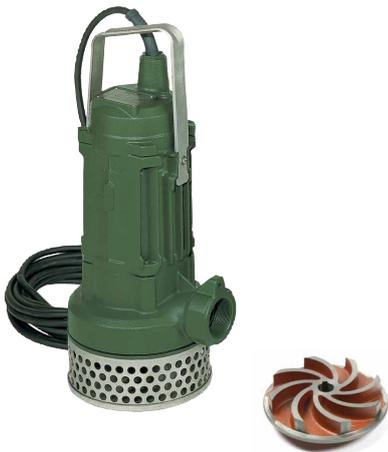
Electrobomba sumergible con cuerpo de la bomba, carcasa del motor, anillo de fricción y rodete de fundición. Disco de fricción de fundición revestido con goma resistente a la abrasión. Eje, manija, filtros, pernos y tornillos de acero inoxidable. Cierre mecánico de carborundo, cámara de aceite inspeccionable.
