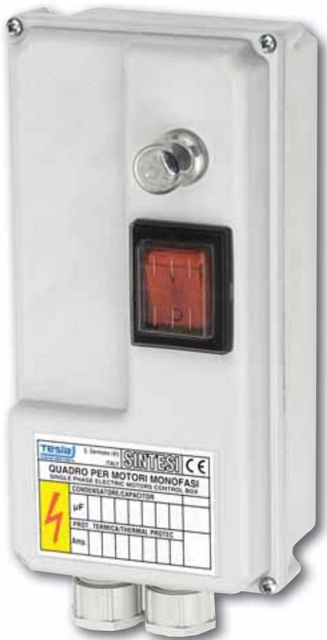
■ Protezione e comando di motore/pompa monofase con avviamento diretto. Scatola in materiale termoplastico antiurto e autoestinguente con due pressacavi. Interruttore generale bipolare luminoso presenza tensione. Alimentazione monofase 230 V +/- 5%. Potenze da 0.5 HP a 3 HP. Grado di protezione IP43. Condensatore di avviamento. Protettore termico con riarmo esterno manuale.
